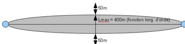
En pratique, on assimile le faisceau à une bande et l'assiette ne dépassera pas 50m de part et d'autre de l'axe :
